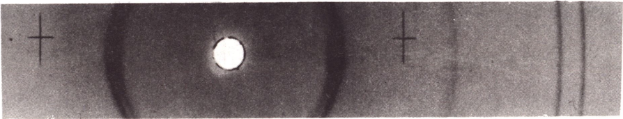
Abb. 4: Röntgen-Rückstrahllinien eines polykristallinen Rastergitters (Au, D = 2000 \text{ \AA} , Glasunterlage), \text{CuK}\alpha -Strahlung (Ni-gefiltert) 40 kV, 24 mA, 1 mm-Parallelblende. Ein lichtoptisch aufkopiertes Markenpaar diente zur Bestimmung der Filmschrumpfung, Einstrahlwinkel \psi = 79^\circ ( \frac{3}{2} ). Proben-schwenkung um \pm 2^\circ . Belichtungszeit 3'.
