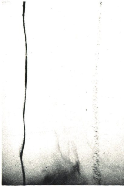
Fig. 3 Blitzlichtaufnahme von fallenden Bronzeteilchen mit zwei verschiedenen Teilchenradien: links ca. 5 bis 25 \mu\text{m} , rechts ca. 50 bis 100 \mu\text{m} ( \rho_F 1,13 \text{g}/\text{cm}^3 , \eta = 6,3 cP, \nu 21,7 Hz)
