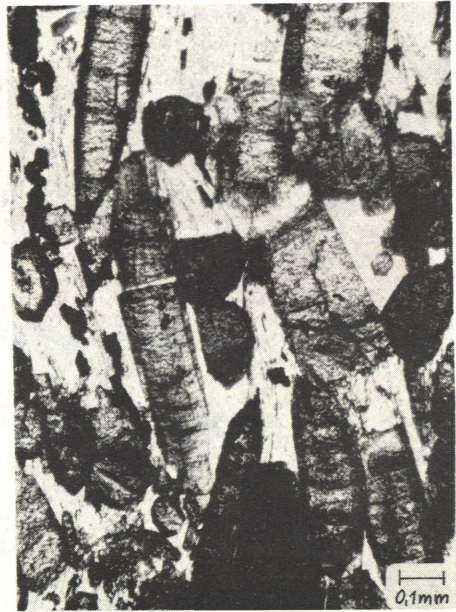
Abb. 12 (links): Ba 3036, M-Lager 400 m-Sohle Nord, Erzlgd. , Dünnschliff; dunkelgrau-grüner Granatschiefer: zerbrochener idiomorpher Granat (untere Bildhälfte), mit Pyritsaum sowie Pyrit in Sprüngen (schwarz), gesproßte große Chlorittafeln (obere Bildhälfte)
