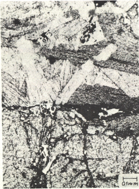
Abb. 12 (links): Ba 3036, M-Lager 400 m-Sohle Nord, Erzlgd. , Dünnschliff; dunkelgrau-grüner Granatschiefer: zerbrochener idiomorpher Granat (untere Bildhälfte), mit Pyritsaum sowie Pyrit in Sprüngen (schwarz), gesproßte große Chlorittafeln (obere Bildhälfte)
