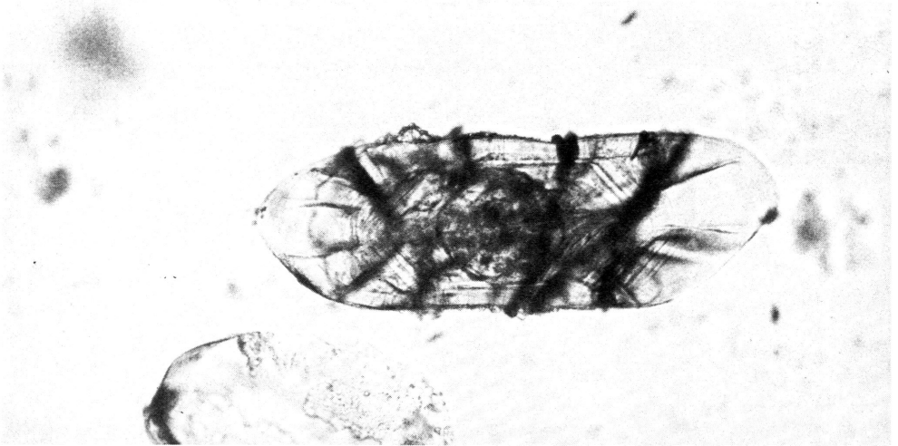
Abb. 12: Ein kleiner, trüber Kern liegt im gut entwickelten System der (101)-Kernhüllen. Die klare Aussenhülle ist stark rissig, obwohl Kern und Kernhüllen sehr wenig "Metamiktisierung" aufweisen. Länge der Bildunterkante = 0,45 mm.
