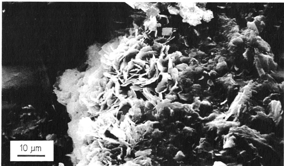
Abb. 3: Rasterelektronenmikroskopische Aufnahme einer Schilfsandsteinprobe aus Setzbachtal (Erläuterungen s. Text) mit "Chlorit-Rosen".
