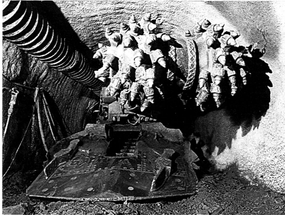
Abb.5: Teilschnitt-Gewinnungsmaschine AM 50 der Voest Alpine Montan AG (Österreich) im Hauptförderstreckenvortrieb des Bergwerks Leonie
