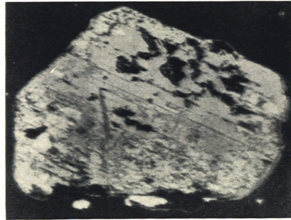
Abb. 20. Maghaemit (hellgrau) verdrängt breiten Kernstreifen eines xenomorphen Magnetitkornes der Ti-reichen Spielart. Neubildungen von Rutil liegen offenbar zufällig nicht in der Schlißfläche. Vergr. 600 \times , 1/7 Fl, \text{Öl} .
