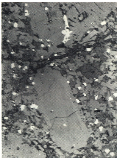
Abb. 10. Verteilung des Magnetit im Basalt von Groschlattengrün. Ein kleiner Teil des \text{Fe}_3\text{O}_4 (nahezu weiß) zonar im Olivin (hellgraue porphyrische Kristalle). Die Hauptmasse ist postolivisch, z. T. sogar postaugitisch. Jüngster Magnetit tritt in Klüften im Olivin auf.
