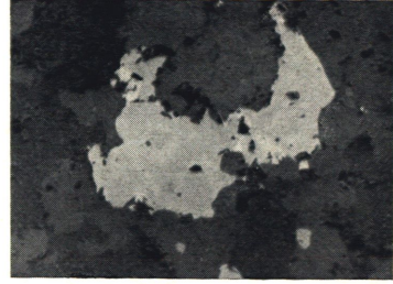
Abb. 18. Zwei Ilmenit-Entmischungslamellen in hoch titanreichen Partien eines xenomorphen Magnetitkornes. Die bei der Entmischung eingetretene „Enttitanisierung“ des Magnetites in der unmittelbaren Nachbarschaft der E-Körper ist im Foto nicht oder kaum zu erkennen. Vergr. 600 \times , 1/7 Fl, \text{Öl} .
