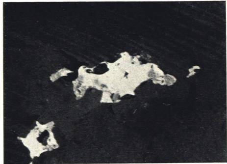
Abb. 12. Entmischter Cubanit (eine einzelne, schmale Lamelle, zartgrau) in Kupferkies (deutlich heller). Daneben Vallerit in verbogenen oder stark gezackten Körnern in Hellstellung, wenig dunkler als Cubanit, in Dunkelstellung mittelgrau. Nahezu schwarz: ZnS-E-Körper. Vergr.  $\sim 250 \times$ , 8 mm Öl, 1 N.
