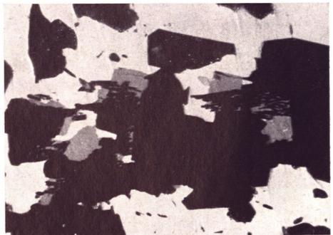
Abb. 10. Wie Abb. 9, aber Nicols gekreuzt. Im Kupferkies (hier dunkelgrau) werden die in Hellstellung befindlichen entmischten Valleriite (weiß) als deutlich in zwei Richtungen orientiert erkennbar. Vergr.  $\sim 150 \times$ , P 3 b, + N.
